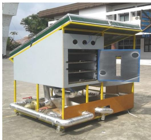
Gambar 1. Photo Pengering dehumidifikasi terintegrasi dengan pemanas udara surya.
